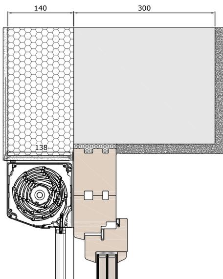
Mit Wärmedämmverbundsystem und Stockaufdoppelung.
