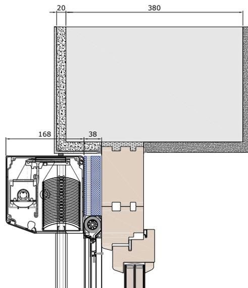
Mit Stockaufdoppelung und Sturzdämmung.
