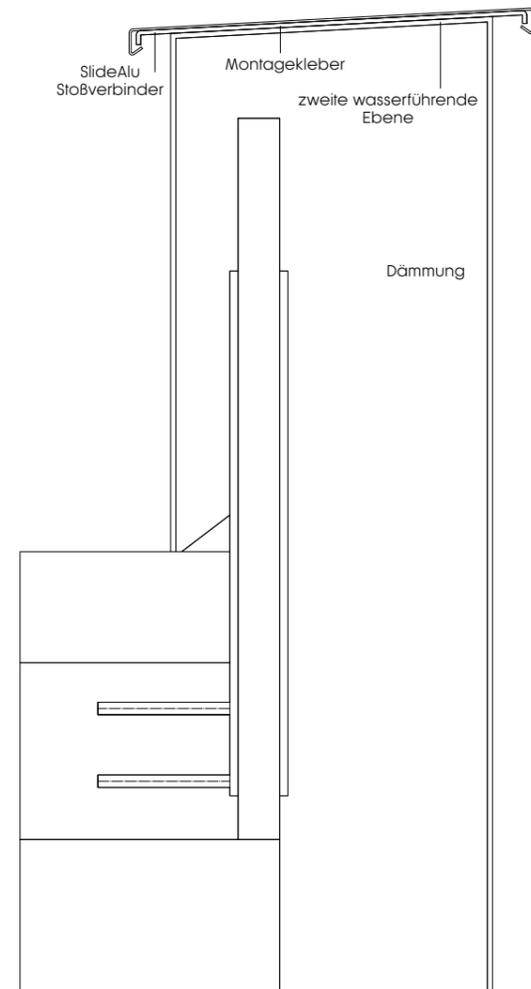
fenorm Aluminium Mauerabdeckung für Systembauteile
