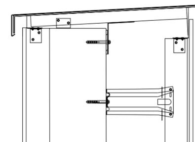
fenorm Aluminium Mauerabdeckung für Wände aus Beton oder Ziegel
