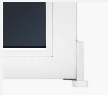
Im Vergleich: Aufliegende Beschlagsteile: Bei einem aufliegendem Beschlag ist die Anschlagdichtung unterbrochen – warme Luft kann eindringen und Tauwasser oder Vereisung verursachen.
