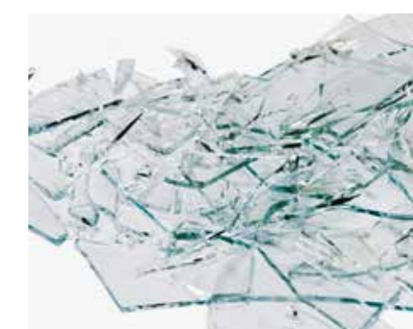
Gewöhnliches Fensterglas zersplittert und der Weg durch das Fenster ist frei.
